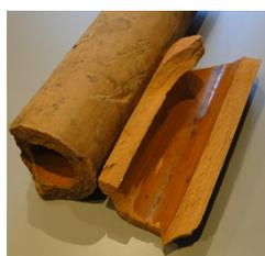
A la fontaine, alimentée par la source dite "En Paradis", sont joints un abreuvoir, un bassin lavoir et une borne fontaine. La conduite d'eau est réalisée avec des tuyaux en terre cuite provenant de la fabrique de poterie de Bletterans. Pour la traversée du ruisseau, elle est protégée par une pièce de chêne équarrie. Les matériaux de construction sont extraits des carrières de Quintigny, d'Arlay et de Crançot, le sable de la Seille. Les travaux sont terminés en 1855.
